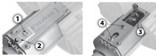
Рисунок 2. Схема установки светильника на кронштейн.
